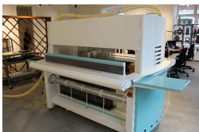
ALFA TC2 12 moduler 4-wide loom frame 2 kædebomme Max. Vævebredde 145 cm
