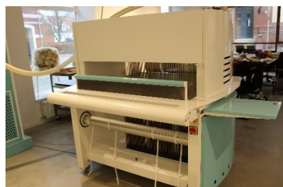
BETA TC2 6 moduler 3-wide loom frame 1 kædebom Max. Vævebredde 109 cm
